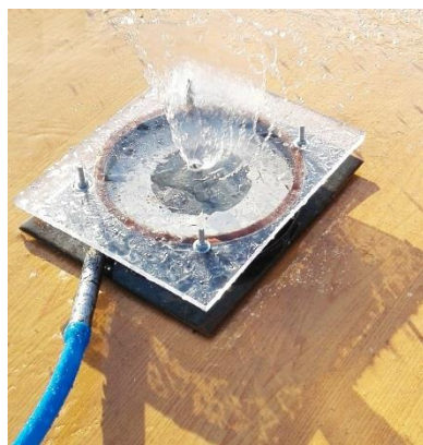
Рис. 2. Визуализация течения воды в короткой вихревой камере
